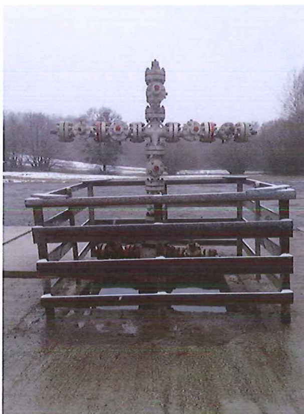
Slika 3. Shematski prikaz nadzemne opreme bušotina Gr-1z i Gr-2z, te izvedena bušotina Gr-2z
